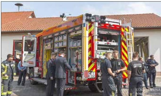
Der Aufbau erfolgte durch die Firma EMPL Fahrzeugwerk GmbH Deutschland in Zahna-Elster. Das Fahrzeug besitzt einen Sprühbalken und einen LED-Lichtmast, welcher über die Fahrzeugbatterie betrieben wird. Neben einem Löschwassertank mit einem Fassungsvermögen von 4.200 l wurden zwei Schaummittel tanks
