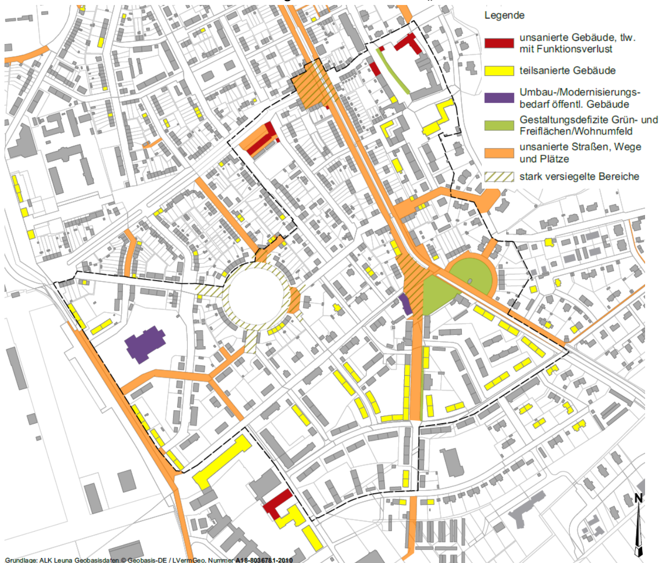
Abb. 11: Städtebauliche Missstände im Fördergebiet Kernstadt Leuna „Mitte“
